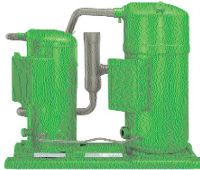
Система работает даже в комбинациях с неравными компрессорами и допускает применение частотных преобразователей в конструкциях много компрессорных чиллеров. Устройство позволяет отказаться от использования активной системы распределения масла с маслоделителем и не требует наличия ведущего компрессора, в который должно возвращаться масло. При этом оптимальное распре-
